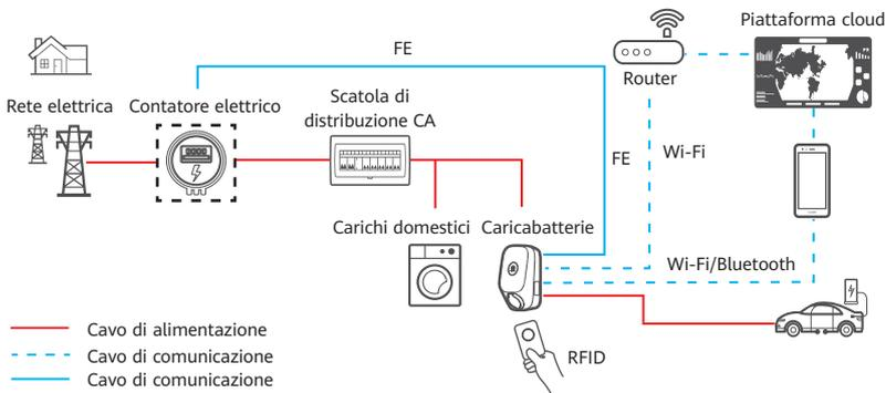
Figura 2: caricabatterie collegato al contatore tramite porta FE e non connesso alla piattaforma cloud
