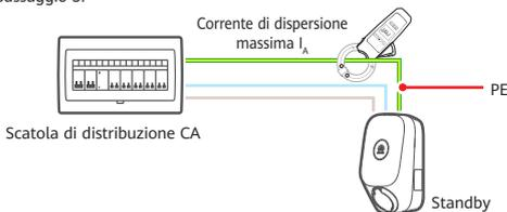
5. Collegare il connettore di ricarica al caricabatterie e avviare la sessione di ricarica. Utilizzare lo stesso metodo per misurare la corrente di dispersione massima del cavo PE a monte  $I_B$ .
